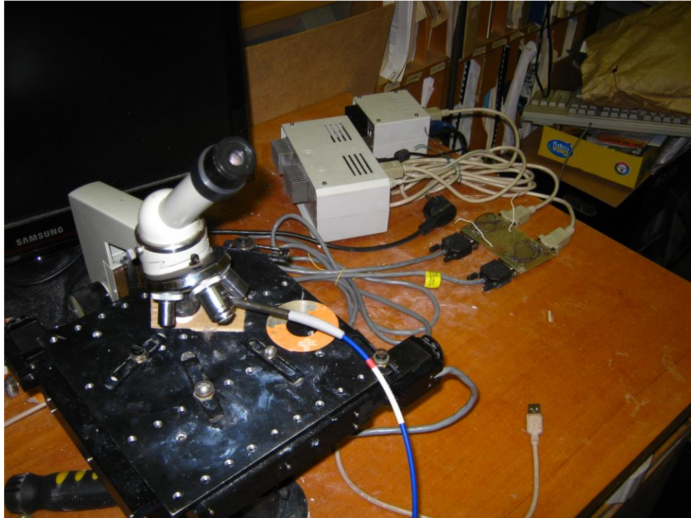
4.1.3. attēls. XY skenējošais koordināšu galdiņš 8MTF-102LS05 un tā vadības bloki.
