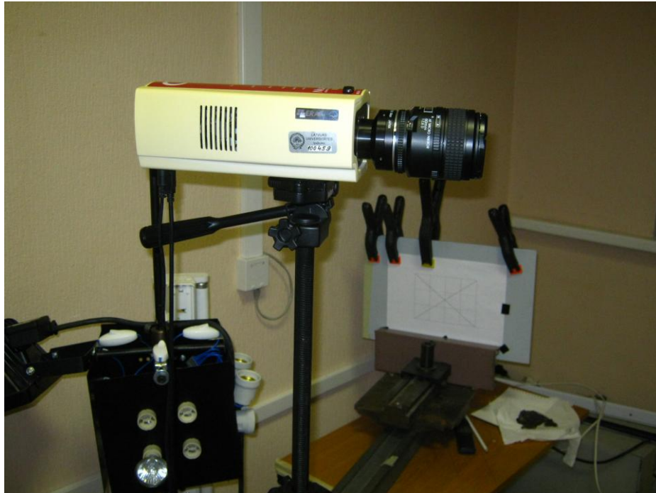
4.1.2. attēls. Multispektrālā kamera CRI Nuance Vis-07 .
