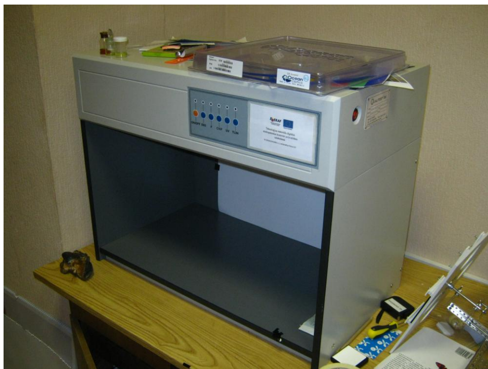
4.1.1. attēls. Gaismas kaste ar dažādiem gaismas avotiem (D65, TL84, CWF, F un UV).
