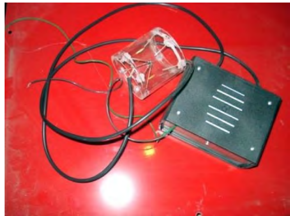
Рис. 2. Ячейка для плазменного электролиза с частично погруженным вольфрамовым проволочным электродом Fig. 2. Plasma electrolysis cell with slightly immersed tungsten wire electrode
